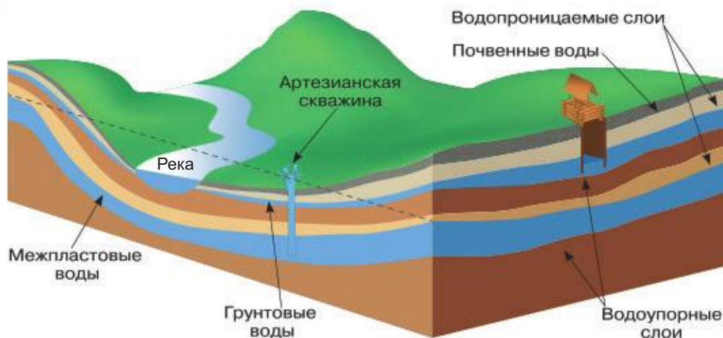
Рис. 88. Залегание подземных вод
